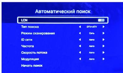
**LCN:** Включение/выключение нумерации ТВ каналов, заданной провайдером.
